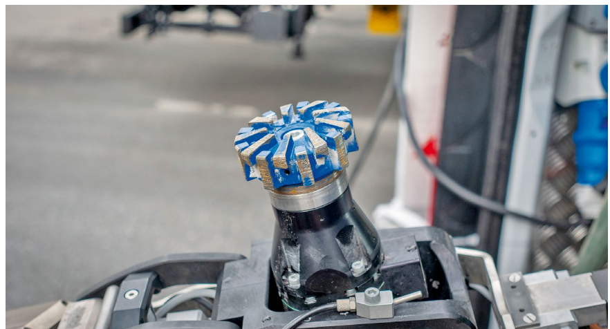
Der Bohrkopf wühlt sich durch die Rohrleitungen, eine Kamera zeigt den Weg.
