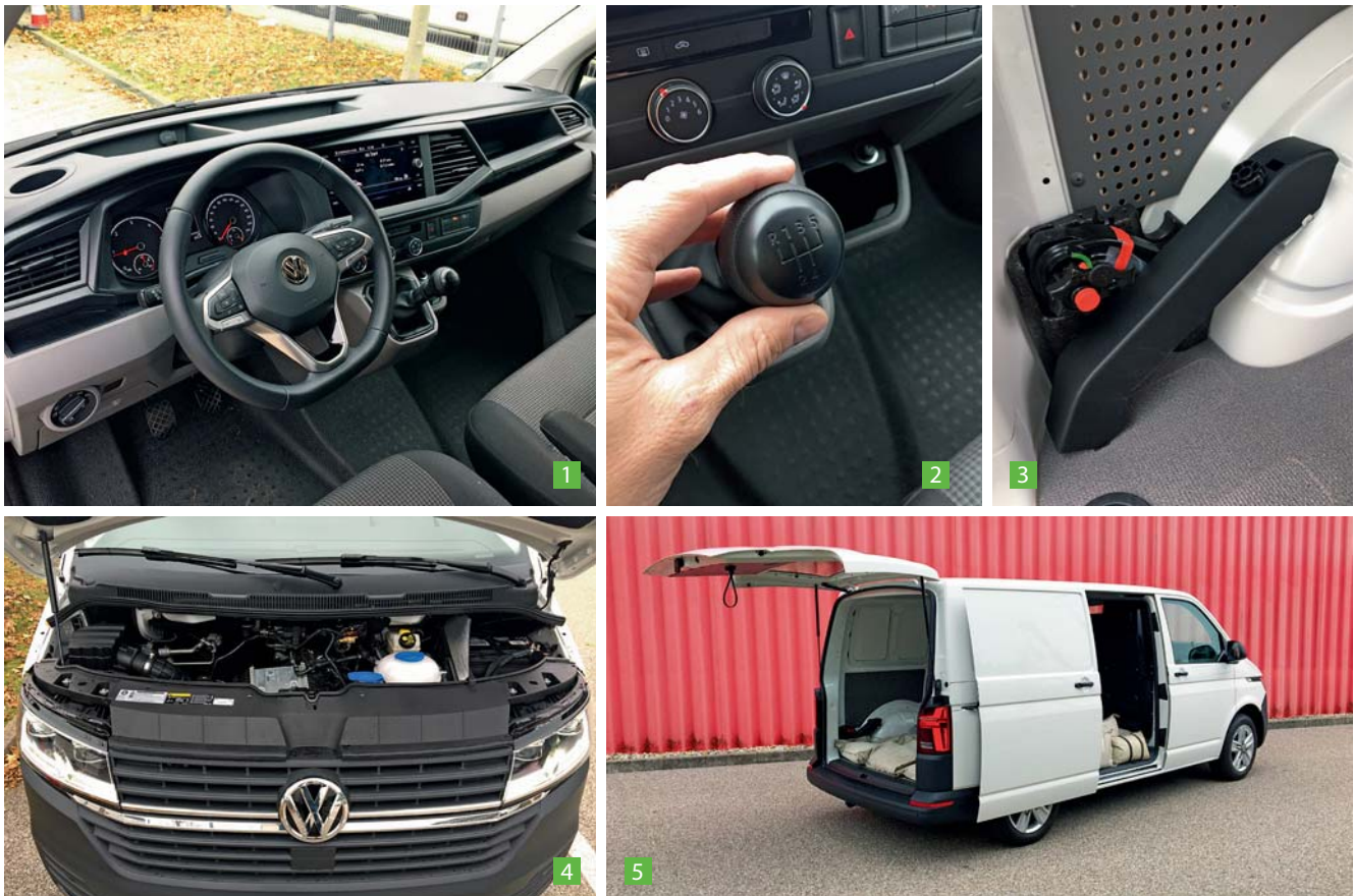
1 Typisch VW: nüchtern gestalteter Innenraum, rätselfreie Bedienung, jetzt mehr Ablagen 2 Bis 110 PS gibt es im Transporter nur fünf Gänge, die sich knackig schalten lassen 3 Da gibt es bessere Lösungen: Nach wie vor lagert das Bordwerkzeug im Laderaum 4 Einziger Diesel für den VW ist der 2,0-l-TDI mit Leistungen zwischen 90 und 199 PS 5 In den T6.1-Kastenwagen mit normalem Radstand (3.000 mm) passen bis zu 5,8 Kubikmeter Fracht (hier mit 700 kg Testballast)
