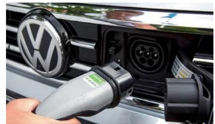
**Schnellladen geht hier nicht: 3,6 kW nimmt der Emdener maximal an**
