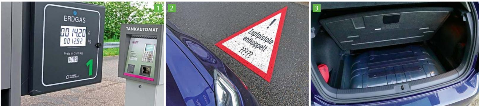
1 Für schmale 1,10 Euro gibt es 100 % sauberes Bio-Erdgas – manchmal leider nur am Tankautomaten 2 Nicht wichtiger als bei der Diesel- oder Benzin-Zapfpistole: Aber beim CNG werden Auto und Zapfanlage (einfach und geruchsfrei) mit einem Umleghebel fixiert. Daher schadet der Hinweis vielleicht nicht 3 Der Kofferraum schrumpft auf 291 Liter, um für die Erdgastanks Platz zu machen
