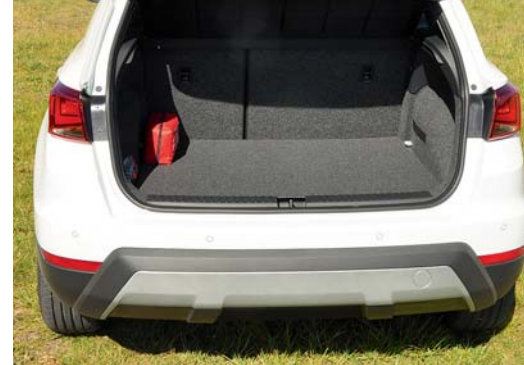
Drei Tanks sind unterflurig verbaut und rauben dem Arona nicht viel an Stauraum
