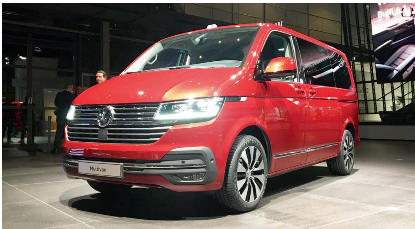
Die Frontmaske im aktuellen VW-Stil inklusive Scheinwerfer sind neu. Der nun erhältliche Abstandsradar (ACC) sitzt unter dem VW-Logo
