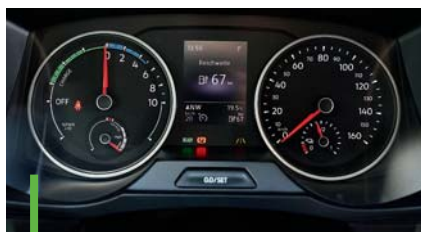
Den Drehzahlmesser hat im e-Crafter die Rekuperationsanzeige ersetzt
