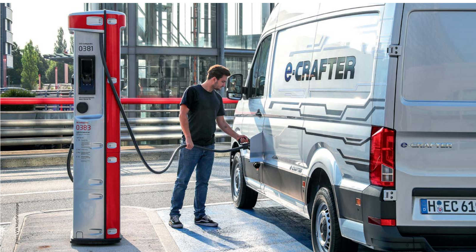
Keine Ewigkeiten – An der Schnellladesäule sind innerhalb von 45 Minuten 80 Prozent des e-Crafter-Akkus geladen
