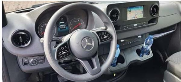
**Neue Welt** | Das Volant und das Display lassen Gefühle wie im Pkw aufkommen. Dafür hat das Lenkrad nun recht viele Steuerelemente und das Display fällt mit sieben Zoll fast zierlich aus
