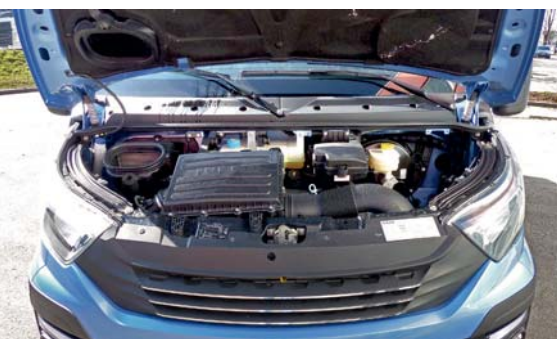
Kleiner Diesel | Das bekannte 2,3-Liter-Aggregat liefert hier mit 116 PS überschaubare Power ab
