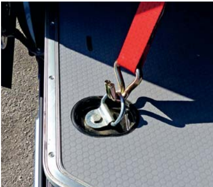
Pflicht | Für die Ladungssicherung sind Zurrösen wichtig. Der Daily hat hier solide Helfer an Bord
