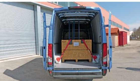
Testladung | Mit 800 Kilogramm ging es auf Tour. Zwischen den Radkästen ist 1,31 Meter Luft
