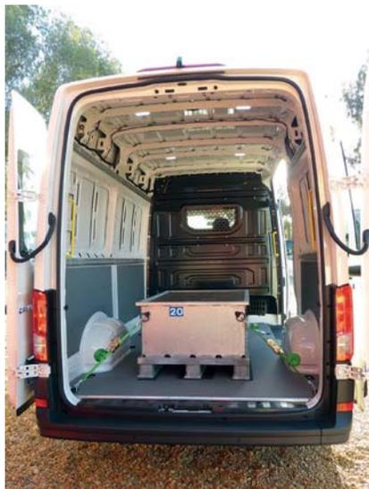
**Packesel** | Der Crafter 35 (mittellang) mit Hochdach stemmt von 620 bis 1.414 Kilogramm
