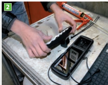
2 Kleben: Da dies nicht der Fall ist, wird das Gehäuse mit zwei Schichten Klebstoff auf den „alten“ VW-Crafter-Spiegel geklebt.
