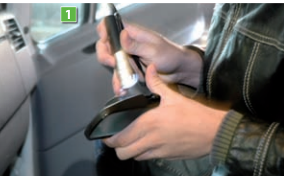
1 Checken: Wollnikom-Außendienstmitarbeiter Björn Truscheit prüft, ob sich Rückspiegel und Kugelgelenk trennen lassen.
