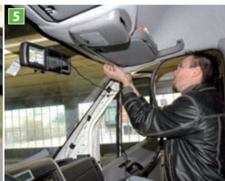
5 Verstecken: Damit keine Kabel im Cockpit stören, verlegt sie der Wollnikom-Mitarbeiter hinter der Verkleidung des Crafters.
