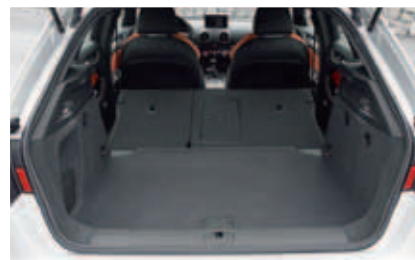
Aufsteigend | Nach dem Umklappen der Rücklehne entsteht ein leicht ansteigender Ladeboden
