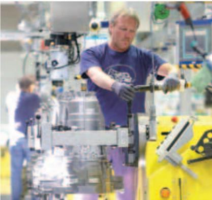
**Große Nachfrage |** Montage des Achtgang-Automatgetriebes für Pkw am ZF-Standort Saarbrücken
