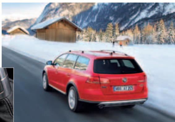
**Schutz von unten** | Um die Ausfahrten ins Gelände schadlos zu überstehen, dient ein Unterfahrerschutz an Front und Heck
