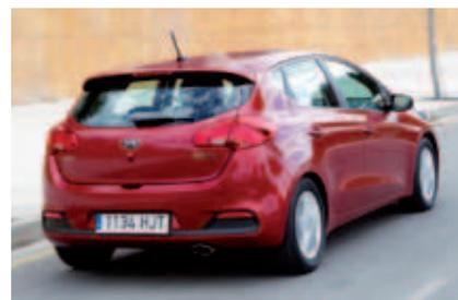
**Ausgedehnt** | Bei Generation zwei wuchs die Spurweite hinten um 32 Millimeter
