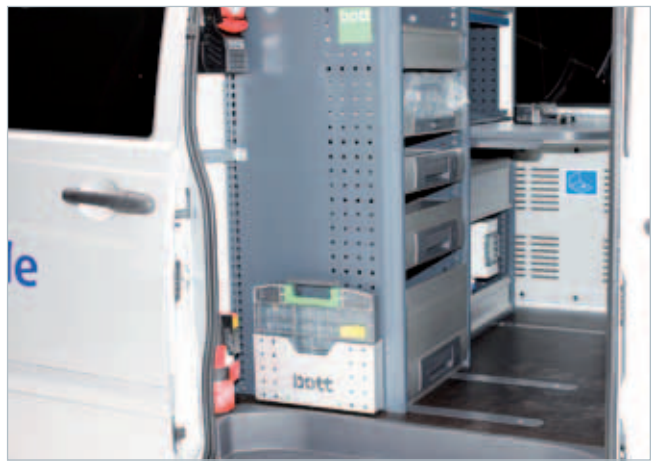
Der vordere Teil des „Laderaums“ dient als Büro- und Prüfarbeitsplatz. Er ist via Seitentür oder direkt vom Fahrerhaus aus erreichbar.
