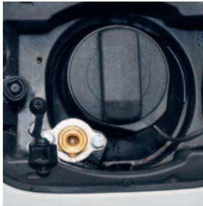
Ebenfalls zum standardisierten Einbau gehört, dass der Einfüllstutzen für den LPG-Tank neben dem normalen Tankstutzen „sitzt“.
