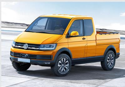
Als Appetit-Happen zeigten die Niedersachsen das extra für die Messe angefertigte Showcar „Tristar“. Der bullige Pritschenwagen mit verlängerter Fahrerkabine, Stylingbar und kurzem Radstand verfügt über einen permanenten Allradantrieb mit mechanischer Hinterachs-Differenzialsperrung. Für die Ladung gibt es zusätzlich unter der Pritsche eine staub- und wasserdichte Schublade.
