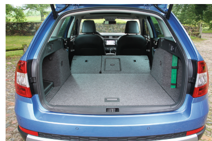
Octavia-DNA | Dank des neuen Allradsystems wächst der Kofferraum auf 1.740 Liter (+ 85 Liter)
