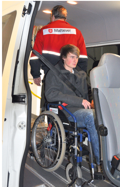
Rollstuhlsicherung nach DIN-Norm | Mit Vergurung und dem im Boden befestigten Kraftknoten
